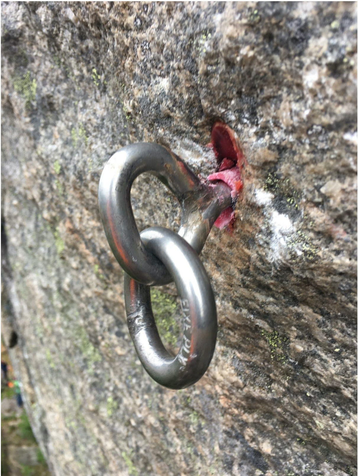
Figur 1 Ankerbolt på Stokastisk etter kraftig manipulering med brekkjern
